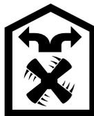
Всасываемый воздух очищается жировулавливающими фильтрами и фильтрами с активированным углём и поступает обратно в кухню.
