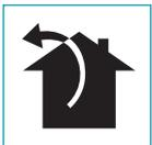
В этой версии дымы и пары выводятся через втягивающий воздухоотвод наружу. Для этой цели выходной патрубков вытяжки должен быть соединен посредством трубы с наружным выходом.
