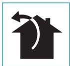
I denna version förs rök och ånga från köket utomhus med hjälp av ett utloppsrör. För detta ändamål måste kåpans utloppskoppling anslutas medels ett rör till ett externt utlopp.
