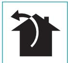
W tej wersji opary i dym są odprowadzane na zewnątrz przez rurę spustową. W tym celu złącze wylotowe okapu powinno być podłączone za pomocą rury do wylotu zewnętrznego.
