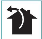
En esta versión, los humos y vapores son canalizados hacia el ambiente exterior a través del tubo de descarga. Para ello, el racor de salida de la campana debe conectarse mediante un tubo, a una salida externa.
