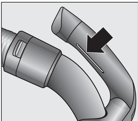
⚠ При уборке возникает естественная статическая электризация. Наэлектризованные частицы могут затем разрядиться. Чтобы предотвратить неприятное воздействие электростатических разрядов, с нижней стороны рукоятки пылесоса встроена металлическая накладка в качестве устройства отвода тока. Поэтому всегда во время уборки старайтесь касаться рукой этой наклейки.
