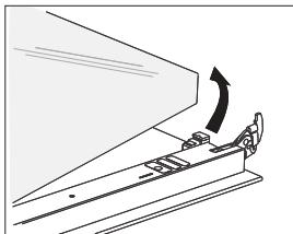
**2** Возмите стекло дверцы за нижний край, немножко приподнимите, чтобы оно освободилось из фиксаторов, и снимите.
