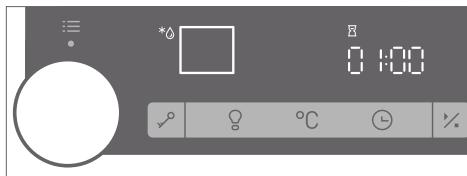
Установите переключатель РЕЖИМА НАГРЕВА в положение «Размораживание».
