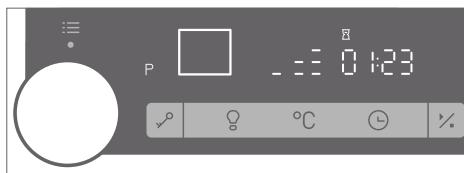
**2** Выберите степень очистки (в зависимости от модели), для этого нажмите на сенсор ТЕМПЕРАТУРЫ и выберите ПЕРЕКЛЮЧАТЕЛЕМ +/– степень очистки.
