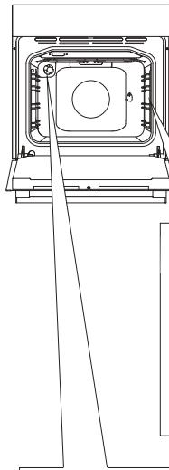
С помощью отвертки подденьте и снимите крышку. Замените лампочку.
