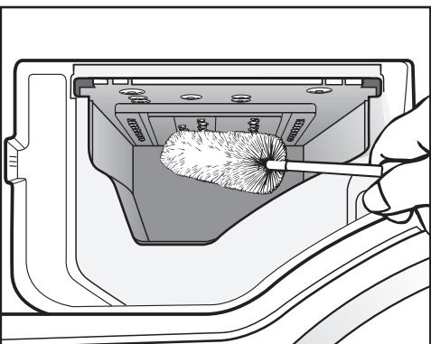
■ С помощью ёршика для мытья бутылок регулярно удаляйте остатки моющих средств и отложения известняка с форсунок подачи воды в отсеке.
