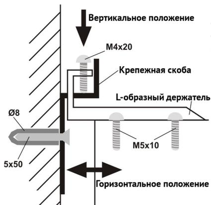
6. После того как Вы установили вытяжку на стену, отрегулируйте вертикальное положение вытяжки винтами, убедитесь что она расположена ровно.
