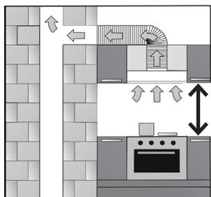
Минимальное расстояние между варочной поверхностью и нижней плоскостью вытяжки должно быть:
