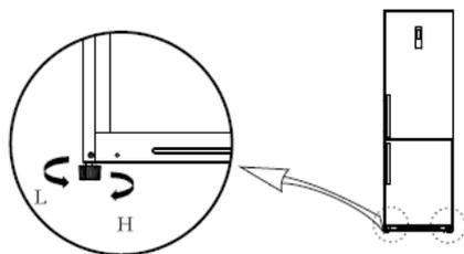
Если холодильник установлен не по уровню, дверь и магнитные уплотнители будут закрываться неплотно.
